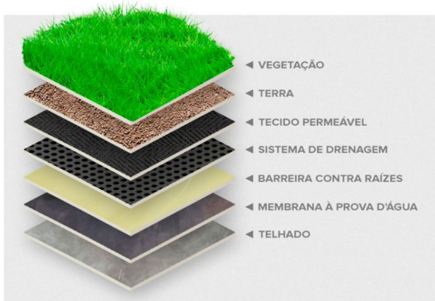
Figura 2 – Camadas do telhado verde
