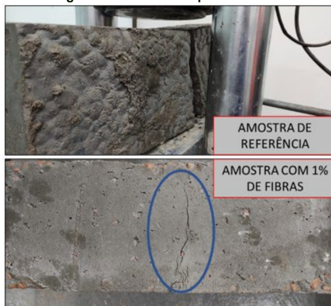
Figura 6 – Modo De Ruptura À Flexão
