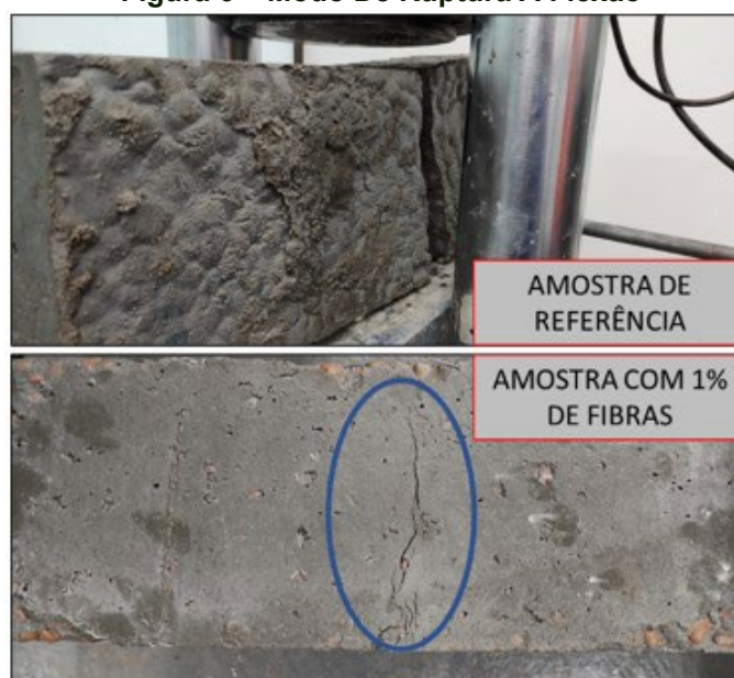
Figura 6 – Modo De Ruptura À Flexão
