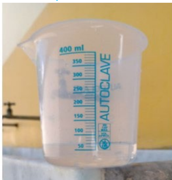
Figura 3 - Becker graduado utilizado para a medição da quantidade da água e cálculo das vazões dos aparelhos de ar-condicionado.
