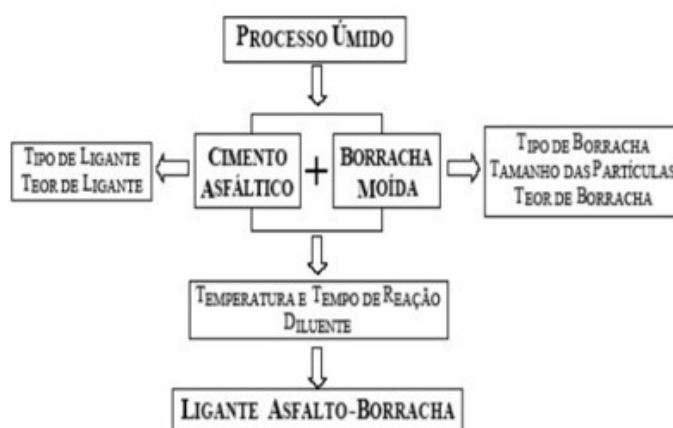
Imagem 3 - Processo do ligante asfáltico.
