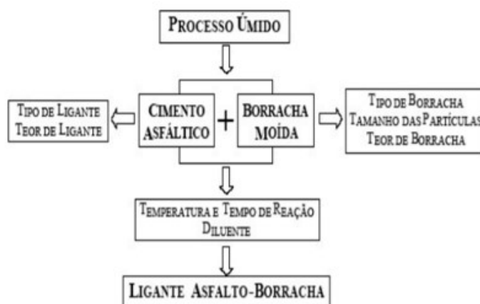
Imagem 3 - Processo do ligante asfáltico.
