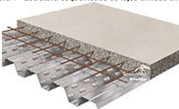
Figura 7 - Estrutura esquemática de lajes úmidas em LSF
