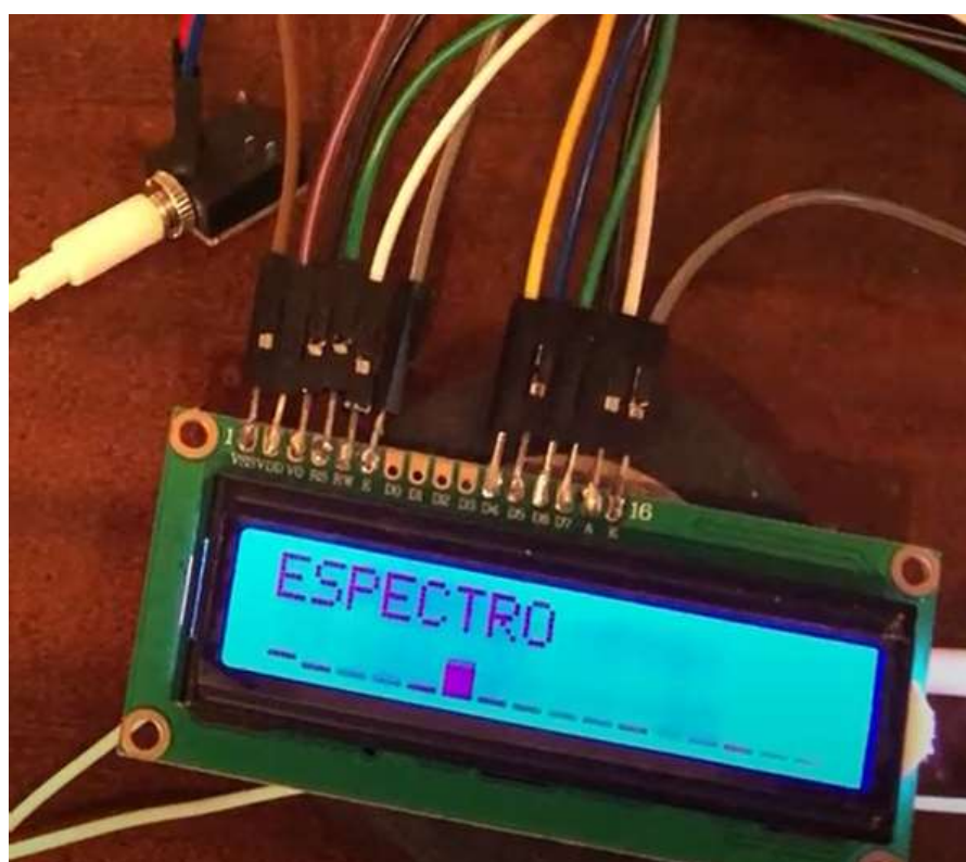
Figura 7 – Espectro da nota Fá (352 Hz)
