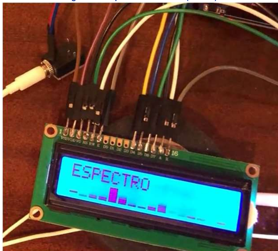
Figura 5 – Espectro da nota Ré (297 Hz)
