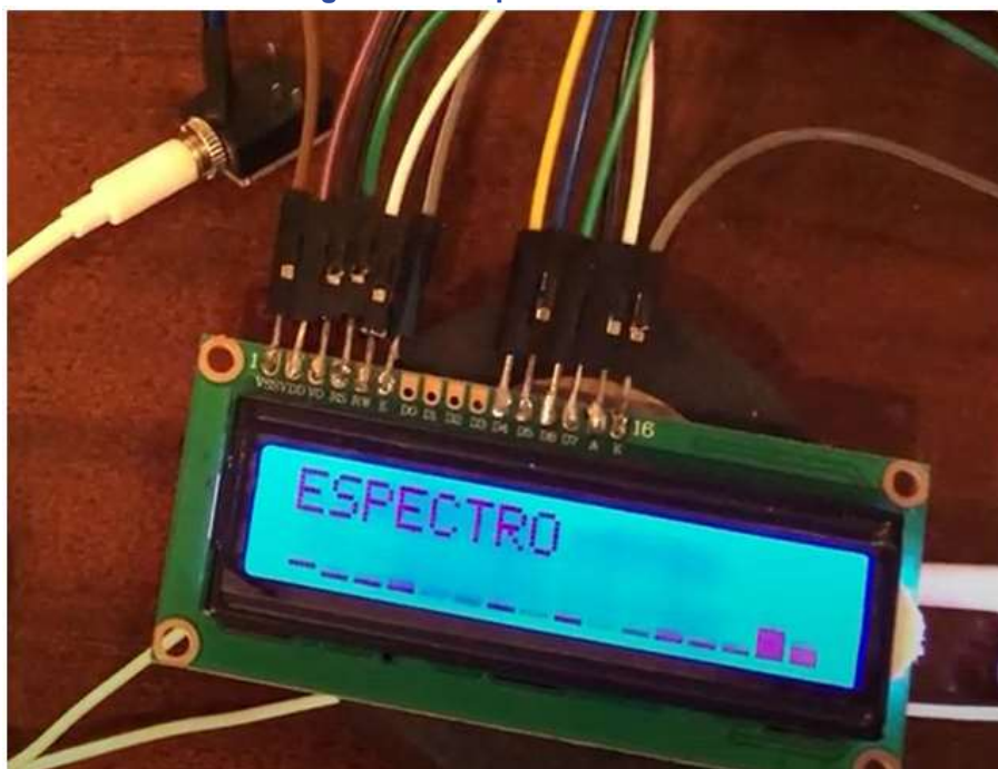
Figura 12 – Espectro de 1 kHz
