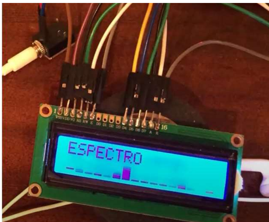
Figura 8 – Espectro da nota Sol (396 Hz)
