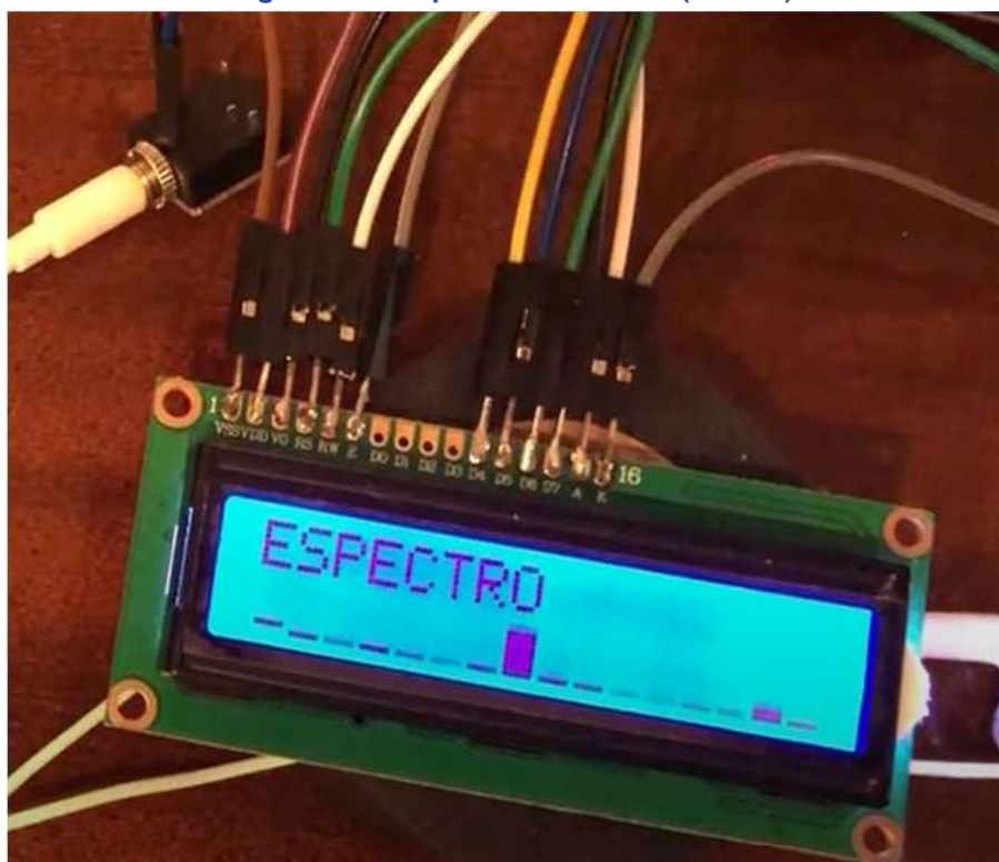
Figura 10 – Espectro da nota Si (495 Hz)
