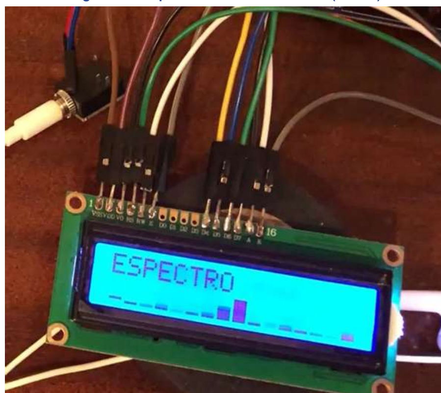
Figura 11 – Espectro da nota Dó oitavado (528 Hz)
