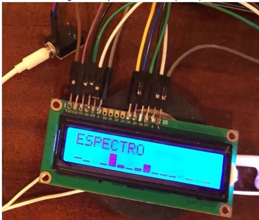
Figura 4 – Espectro da nota Dó (264Hz)
