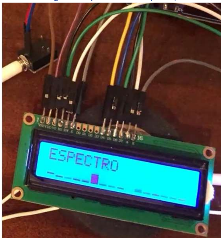
Figura 6 – Espectro da nota Mi (330 Hz)
