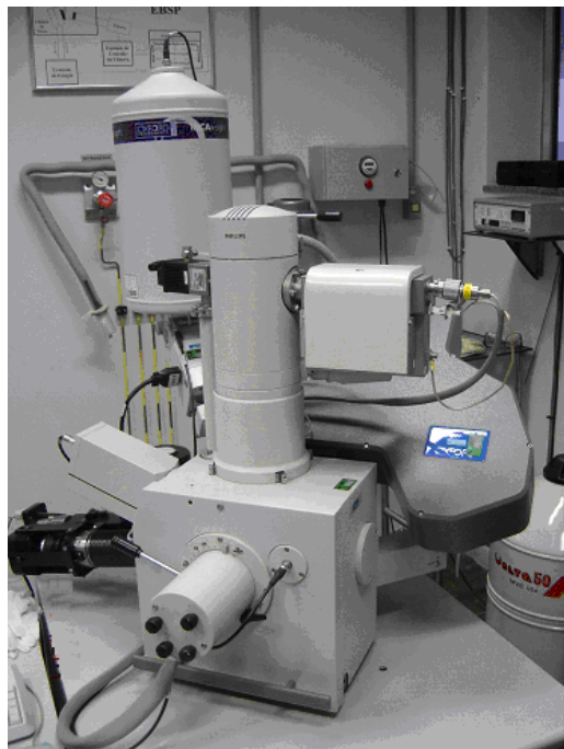
Figura 4.4 - Microscópio eletrônico de varredura do laboratório de métodos físicos do Centro de Pesquisas da ArcelorMittal Inox Brasil.
