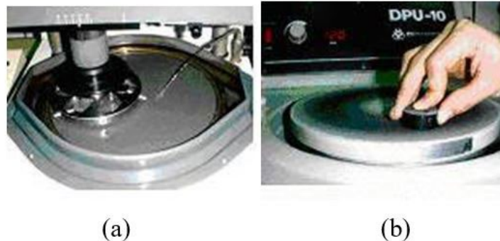
Figura 4.2 - Lixadeira e Politriz utilizadas para: (a) lixamento e (b) polimento
