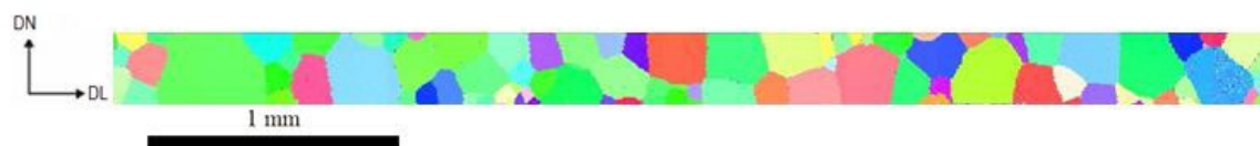
Figura 5.37 - Mapas gerados por EBSD/OIM: (a) figura de pólo inversa; (b) mapa de qualidade de imagem (IQ) com as identificações e as frações em área das fibras analisadas; (c) imagem da distribuição dos fatores de Taylor e suas frações para a amostra submetida a uma temperatura de recozimento final de 1060°C.
