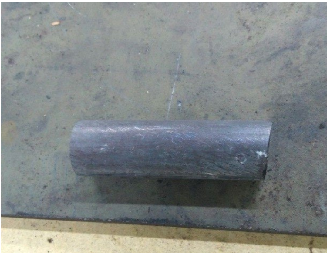
Figura 4 - Amostra de aço AISI 304 retirada da vara para ensaios
