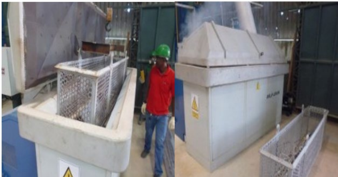
Figura 2 - Procedimento de decação térmica realizado por empresa terceirizada
