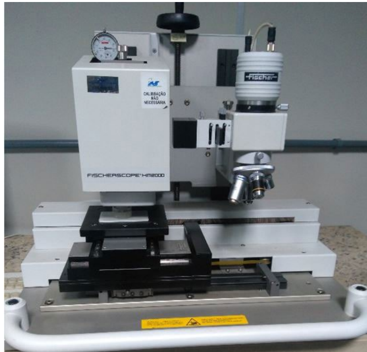
Figura 7 - Microdurometro Fischerscope, modelo HM-2000
