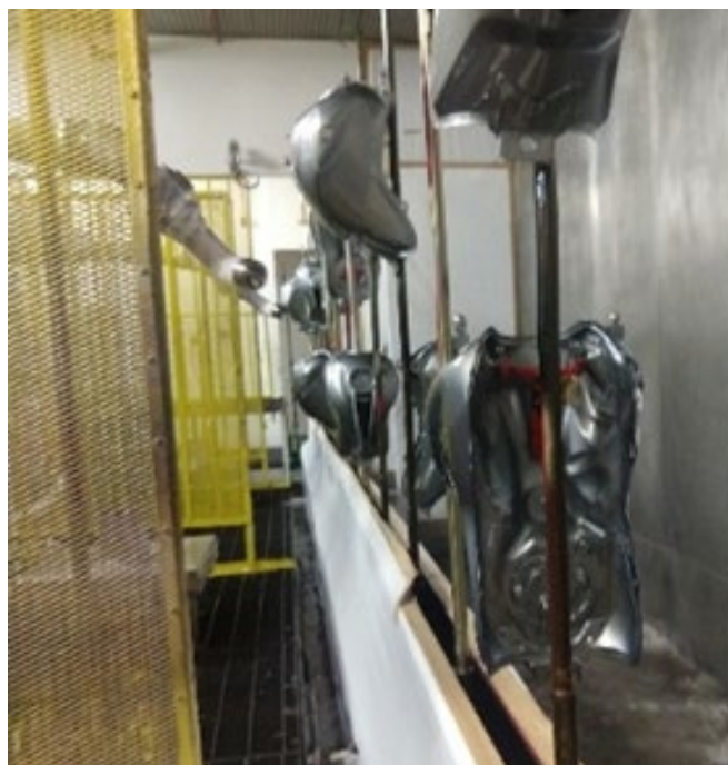
Figura1 - Vara de aço austenítico AISI 304 utilizada para sustentação de tanques durante o processo de pintura
