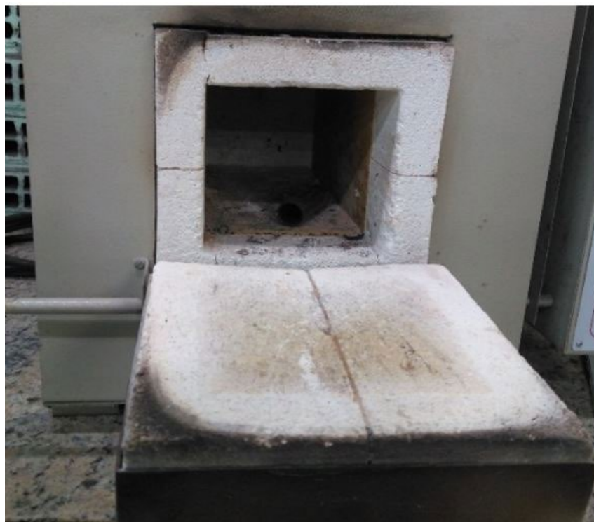
Figura 5 - Simulação do procedimento de decapagem térmica realizado em laboratório
