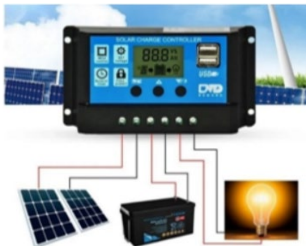
Figura 12 – Ligação do Controlador de Carga
