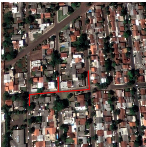
Figura 2 - Traçado da rede de drenagem
