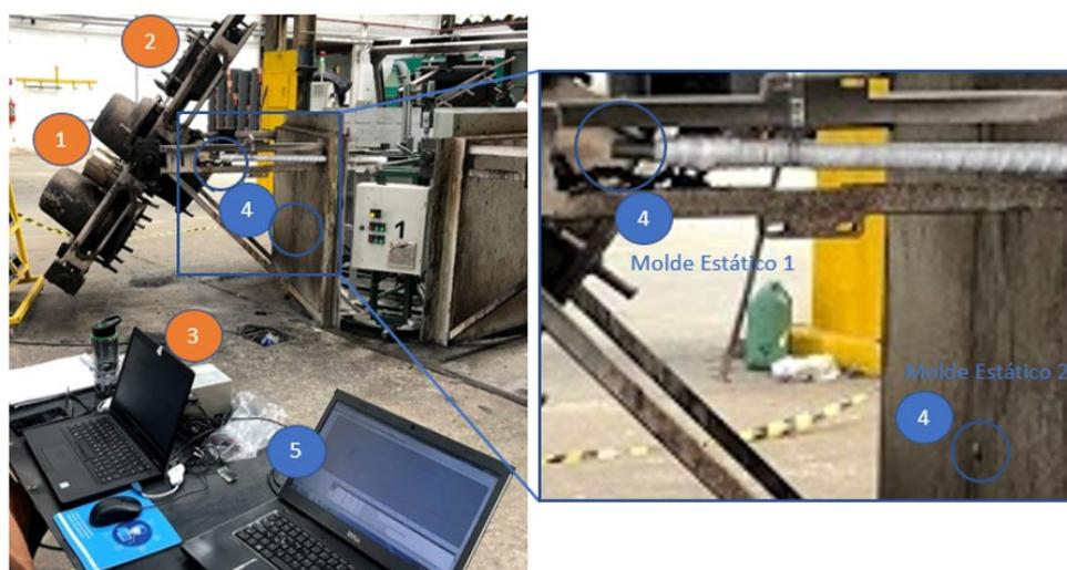
As medições dos dois dispositivos estáticos e do molde de produção foram realizadas conjuntamente em 3 ciclos completos. O gráfico dos ciclos do Molde Estático foi apresentado inicialmente separadamente e respondeu o primeiro objetivo específico deste experimento, quanto a estabilidade dos ciclos e diferença caso exista entre o Molde Estático 1 e Molde Estático 2.
