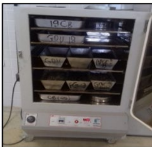
Figura 5 - Amostras de brita e cascalho na estufa
