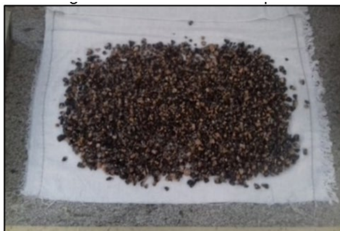
Figura 3 - Secagem do cascalho em um pano absorvente
