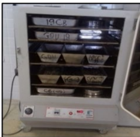
Figura 5 - Amostras de brita e cascalho na estufa
