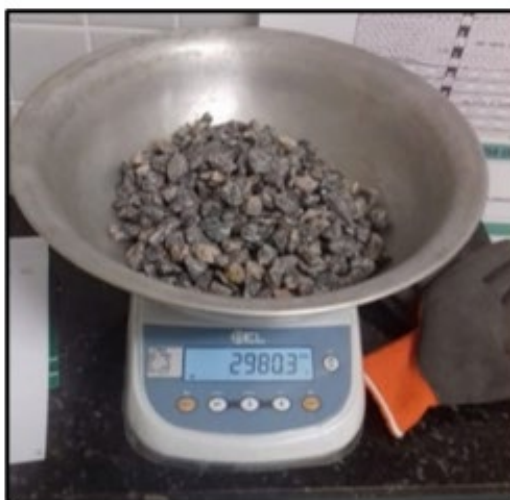
Figura 6 - Pesagem da brita seca
