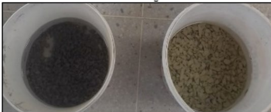
Figura 2 - Cascalho calcário e brita granítico submersos em água
