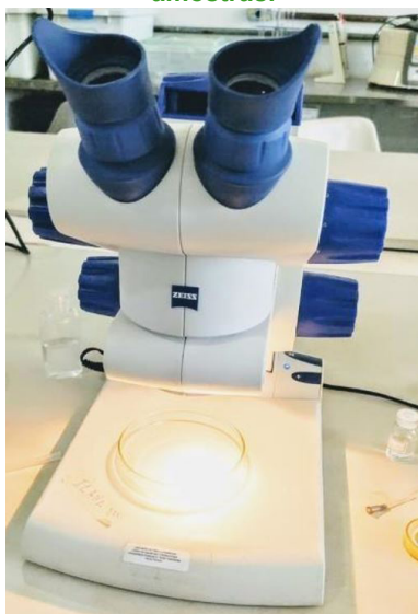
Figura 6 – Estereomicroscópio utilizado para a análise visual das amostras.
