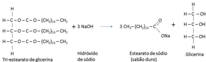
Figura 4 - Reação de saponificação, hidrólise alcalina de óleos na preparação de sabão.
