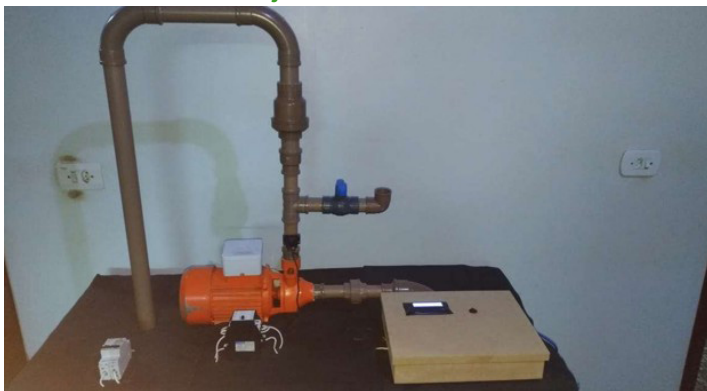
Figura 11 - Sistema de segurança para verificação de escorva do conjunto motobomba.
