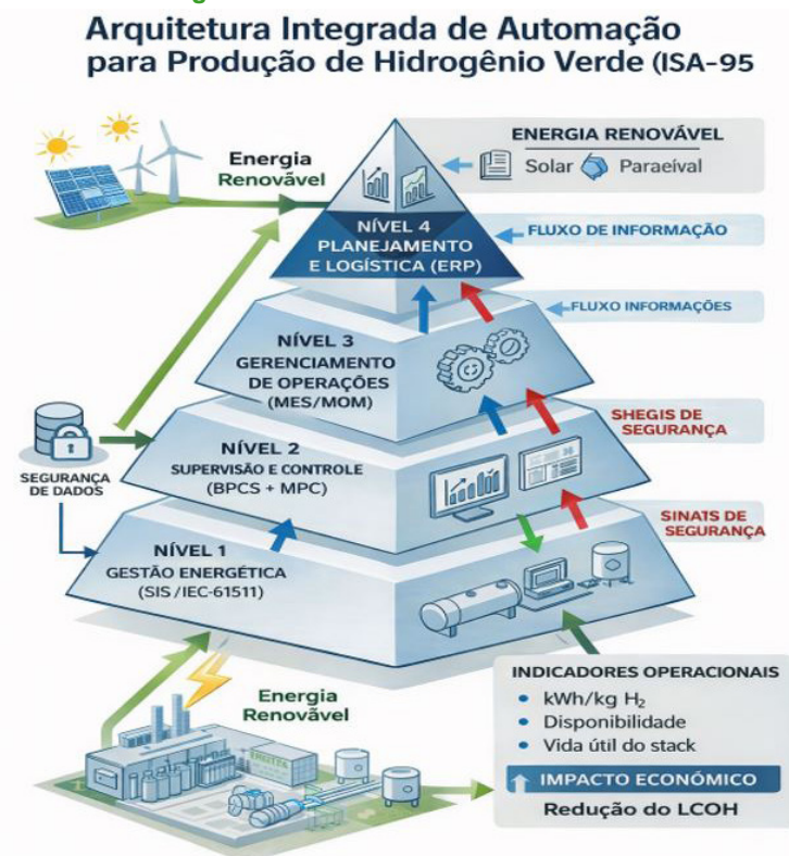
Figura 4 – Arquitetura integrada de automação para produção de hidrogênio verde baseada no modelo ISA-95.
