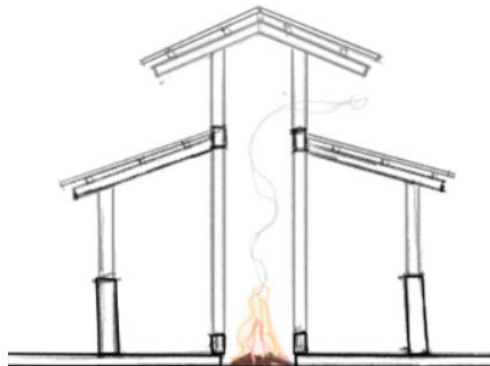
Figura 25 - Croqui esquemático em corte ventilação cobertura.
