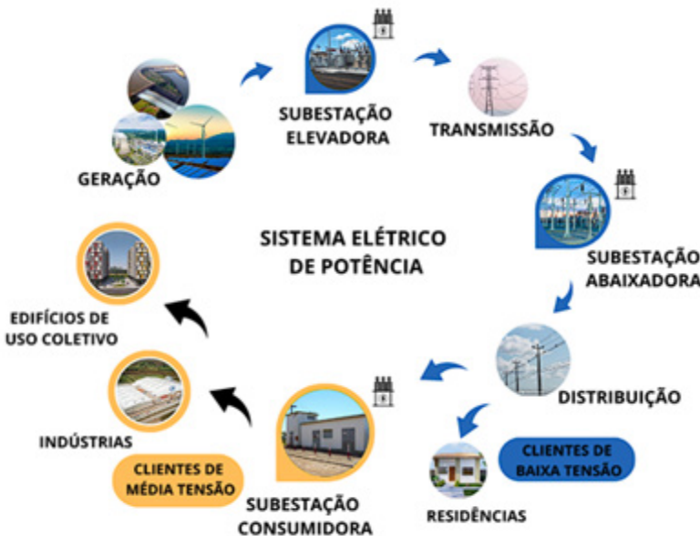
Figura 1 - Aplicação das subestações dentro do Sistema Elétrico de Potência.
