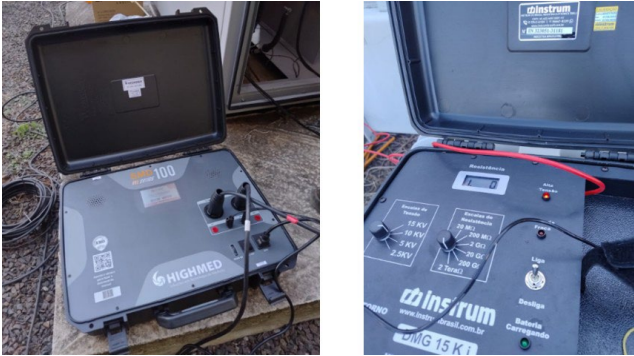
Imagem 6 – Ensaio com o Megômetro e Microhmímetro na Chave Seccionadora.
