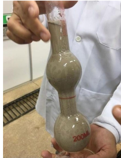
Figura 10 – Frasco de Chapman depois de agitado.
