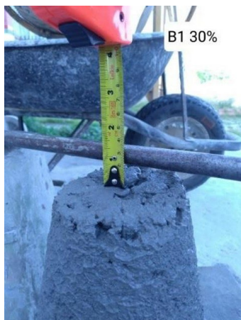
Figura 3 - Abatimento brita 1 com adicional de 30% RCD.
