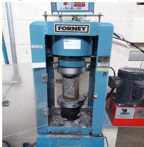
Figura 1 – Corpo de prova rompido.
