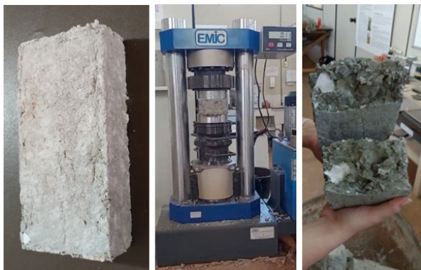
Figura 2 – Bloco Desformado, Teste de Carga a Compressão e Bloco Rompido.
