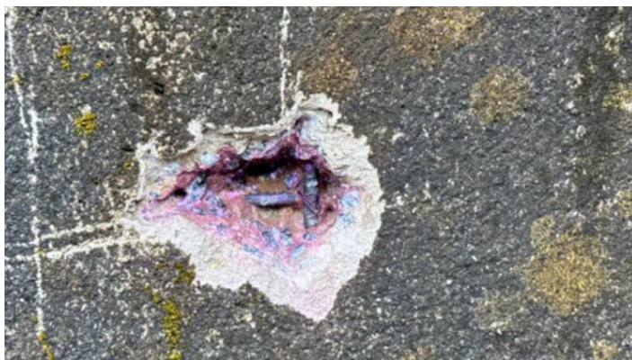
Figura 7 - Aplicação de fenolftaleína diretamente em janela na parede do Reservatório.
