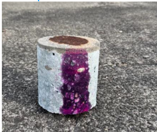
Figura 6 - Aplicação de fenolftaleína em corpo de prova extraído da parede do Reservatório.
