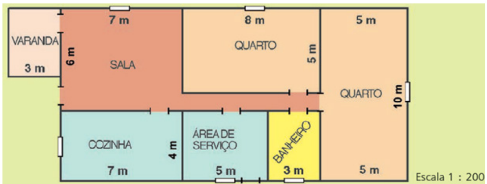
Figura 4 – Representação da planta baixa de uma residência
