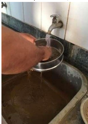
Figura 9 – Ensaio de determinação de material fino passante na peneira de 0,075 mm.
