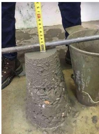
Figura 12 – Abatimento para substituição com 5% do pó da pedra Morisca.
