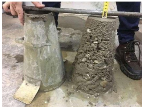
Figura 11 – Abatimento para o traço de Referência.
