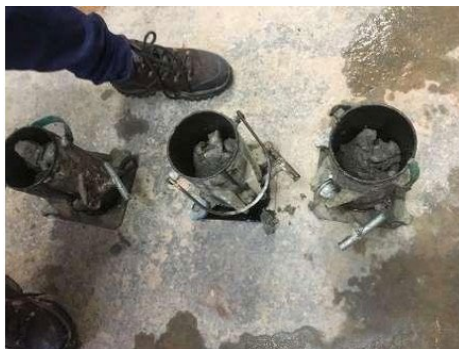
Figura 6 – Moldagem de corpo de prova.
