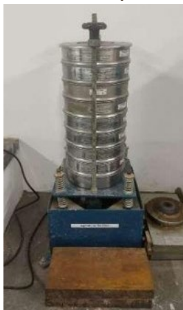
Figura 8 – Ensaio de peneiramento.
