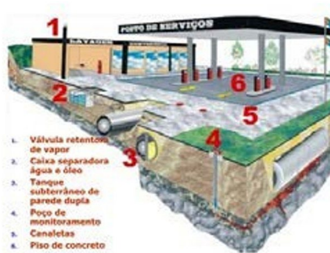
Figura 2 - Equipamentos e sistemas de um posto de abastecimento de combustível: adequação ambiental dos postos de revenda de combustíveis.
