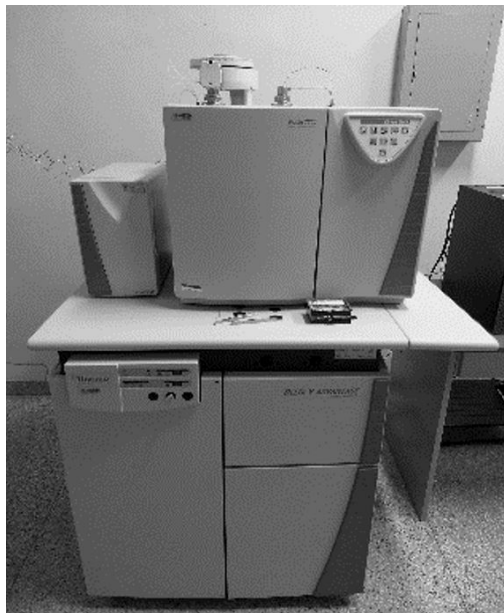
Figura 6 - Espectômetro de Massa de Razão Isotrópica.
