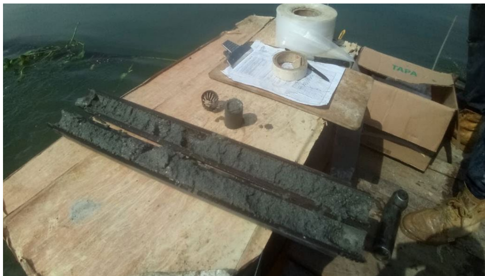
Figura 5 - Tipos de muestra recolectados a profundidades que oscilan entre 16m y 18m de profundidad.
