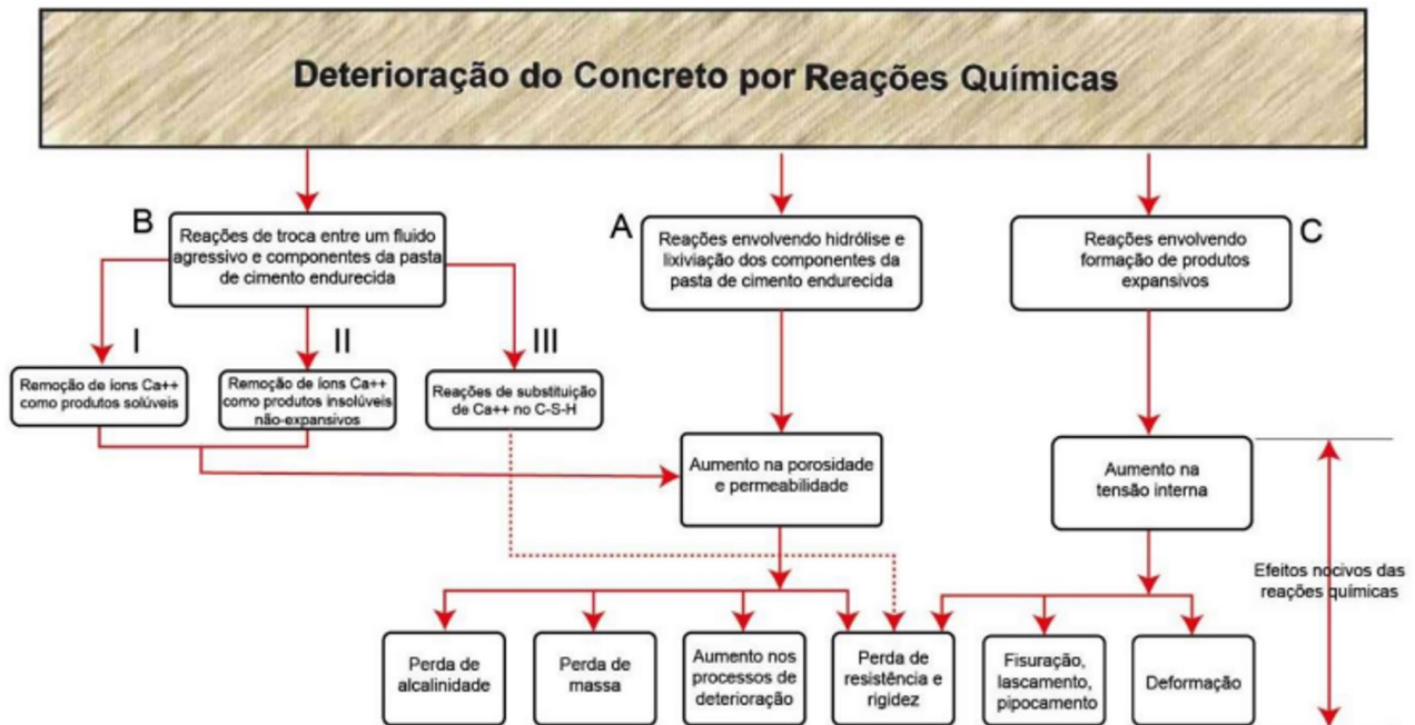
Figura 2 - Deterioração do concreto por reações químicas.
