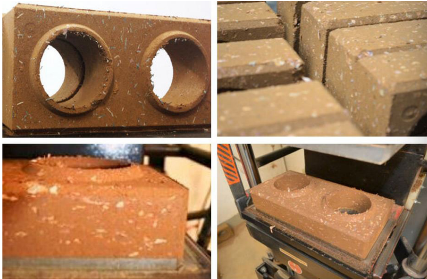
Figura 1 - Tijolo ecológico confeccionado com cédulas de dinheiro sem valor.
