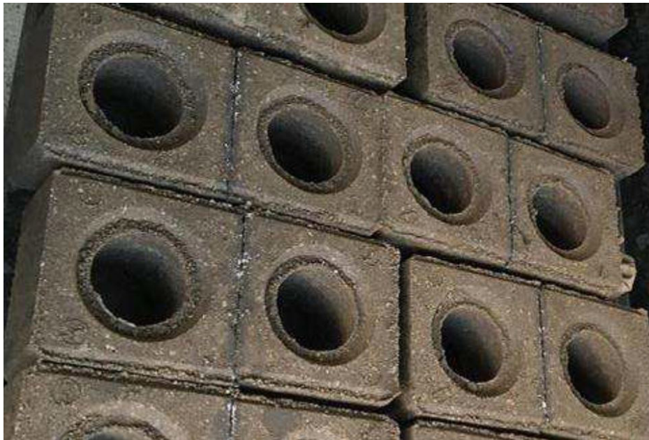
Figura 2 - Tijolo ecológico constituído de solo e resíduo de casca de farinha.
