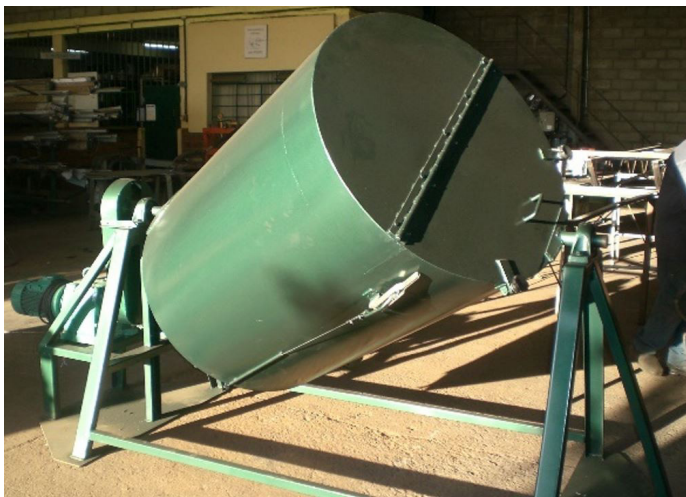
Figura 25 - Aspecto geral de uma betoneira elétrica, utilizada para misturar os componentes do substrato.
