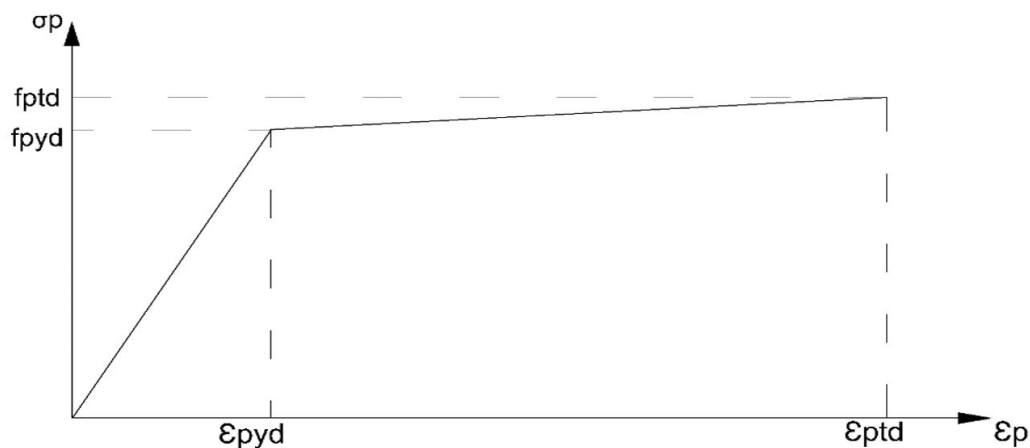
Figura 2 - Gráfico tensão-deformação do aço da armadura ativa.
