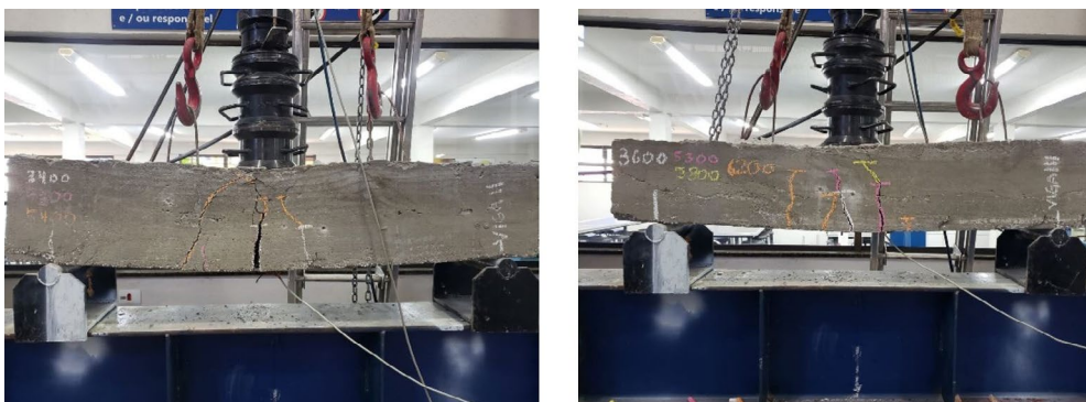
Imagens 1 e 2 - Vigas fissuradas
