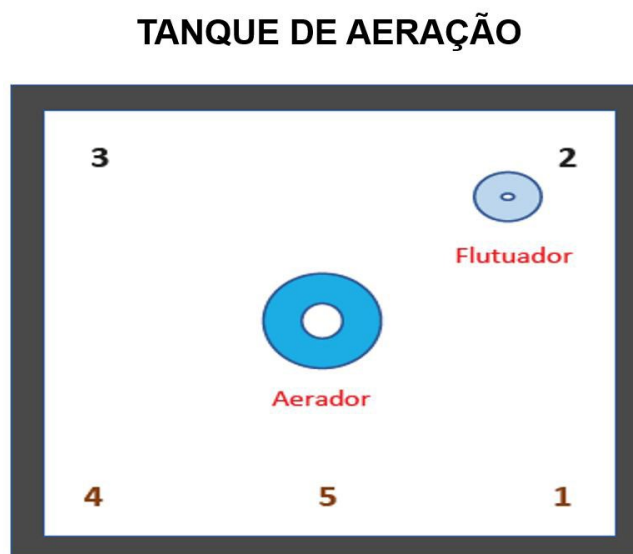
Figura 3 - Representa a vista superior do tanque de aeração com identificação dos pontos de medição de O.D.
