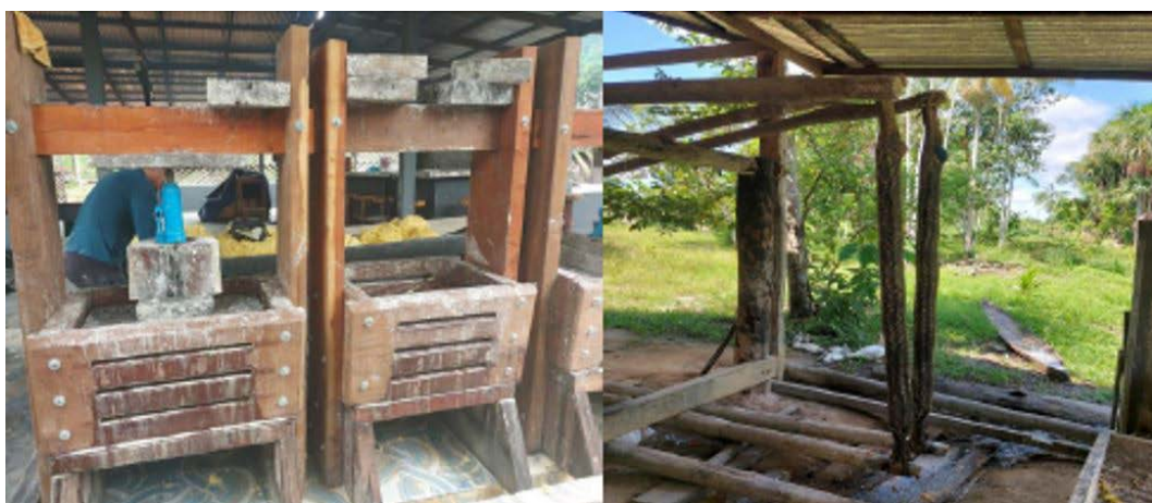
Figura 10 - Secagem (secagem da mandioca), após passar pelo triturador, é feita através de um utensílio conhecido como tipiti ou, de um outro, conhecido como prensa. os dois métodos têm o objetivo de retirar todo o excesso de água, contido na mandioca, durante o período em que ficou na água para amolecer.
