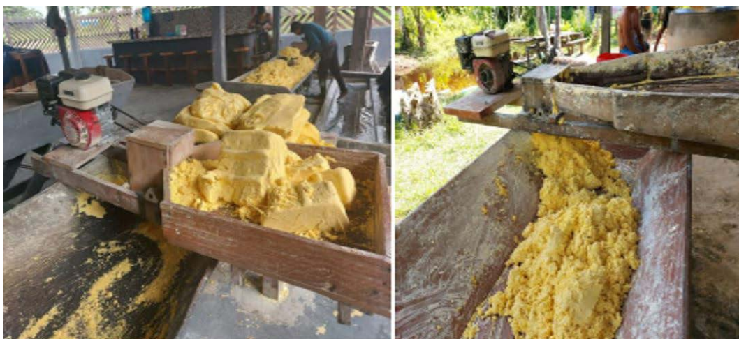
Figura 9 - Sevação (após a retirada das cascas), a mandioca é levada a um triturador, esse equipamento é conhecido como sevador, aqui a mandioca é transformada em massa.
