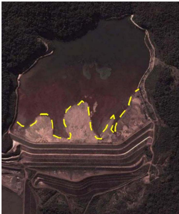
Figura 34 - Barragem B I com a praia começando a ser formada em 2012 (linha amarela tracejada), mas ainda com finos perto do barramento.
