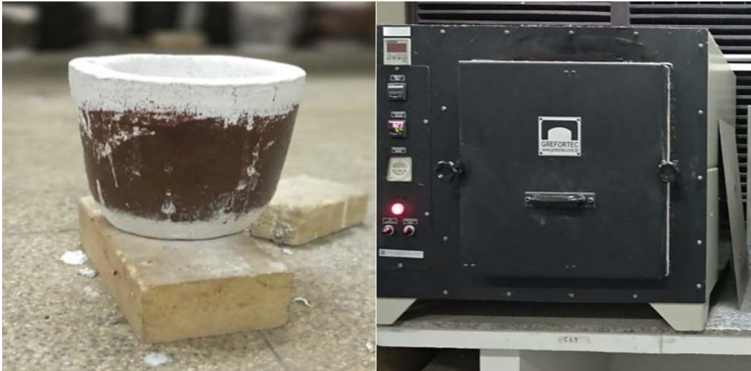
Figura 1 - (a) Cadinho pintado com caulim; (b) Forno usado na fundição.
