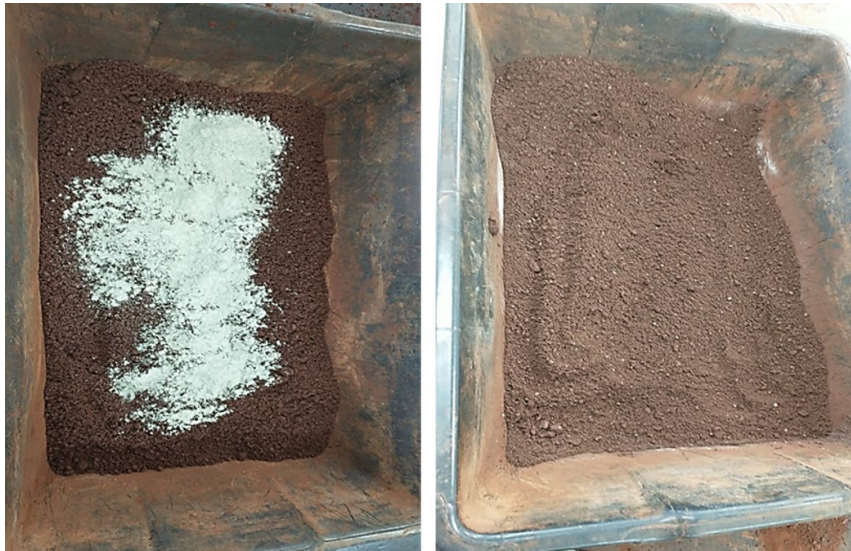
Figura 2 - Homogeneização da mistura solo-cimento.
