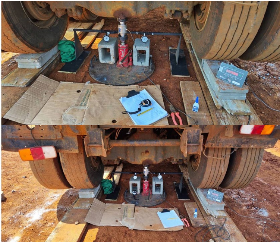
Figura 8 – Prova de carga em placas.
