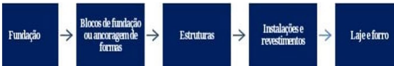
Figura 3 - Etapas construtivas com formas de ICF.
