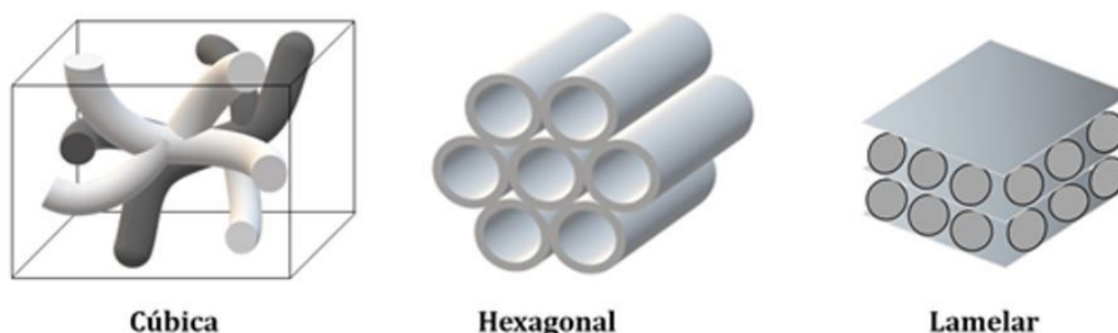
Figura 1 - Demonstração de arranjo estrutural para algumas sílicas da família M41S. Adaptado de (NGUYEN; NGUYEN; VO; NGUYEN et al. , 2020)
