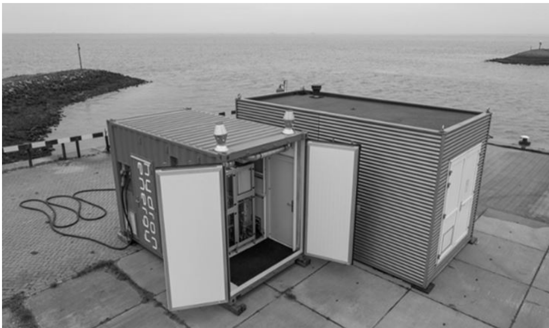
Figura 4 - Produção hidrogênio a partir da água salgada, acoplado a um aerogerador eólico.
