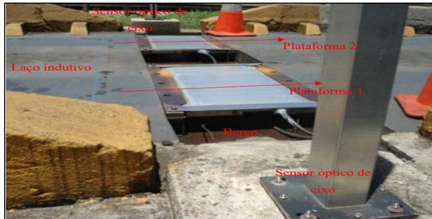
Figura 2 - Sistema de pesagem com células de carga.
