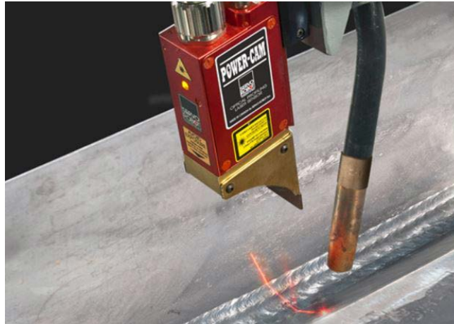
Figura 12 – Robô utilizando laser sensor para se guiar no chanfro.
