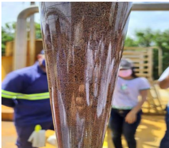
Figura 1 – Lodo utilizado no tratamento da água residuais na Ambev.
