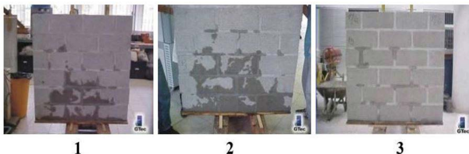
Figura 8 – Teste laboratorial de permeabilidade e estanqueidade em paredes com blocos de concreto
