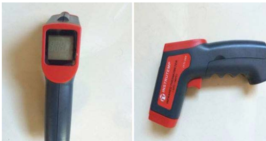
Figura 27 – Instrutemp ITTI 380 Sensor, utilizado para as medições.
