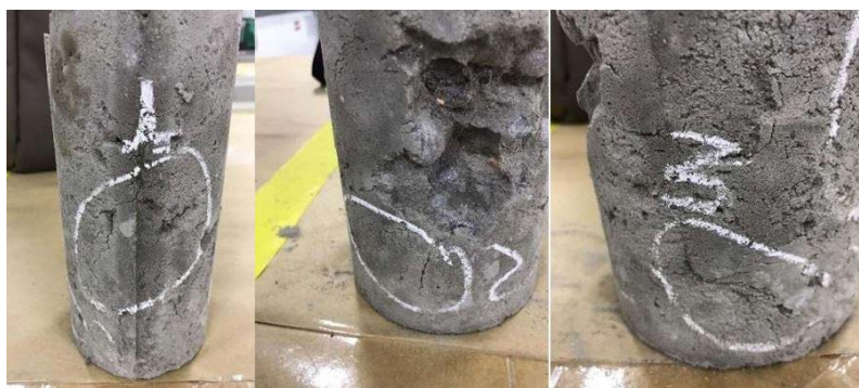
Figura 24 - Fissuração primeiro dia - CP1.
