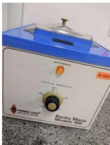
Figura 7 – Banho- maria utilizado para aquecimento da água.
