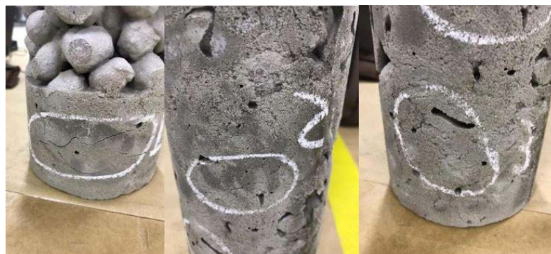
Figura 25 - Fissuração primeiro dia – CP2
