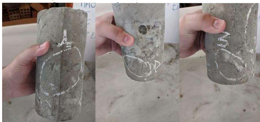
Figura 28 - Fissuração após 2 semanas – CP1.
