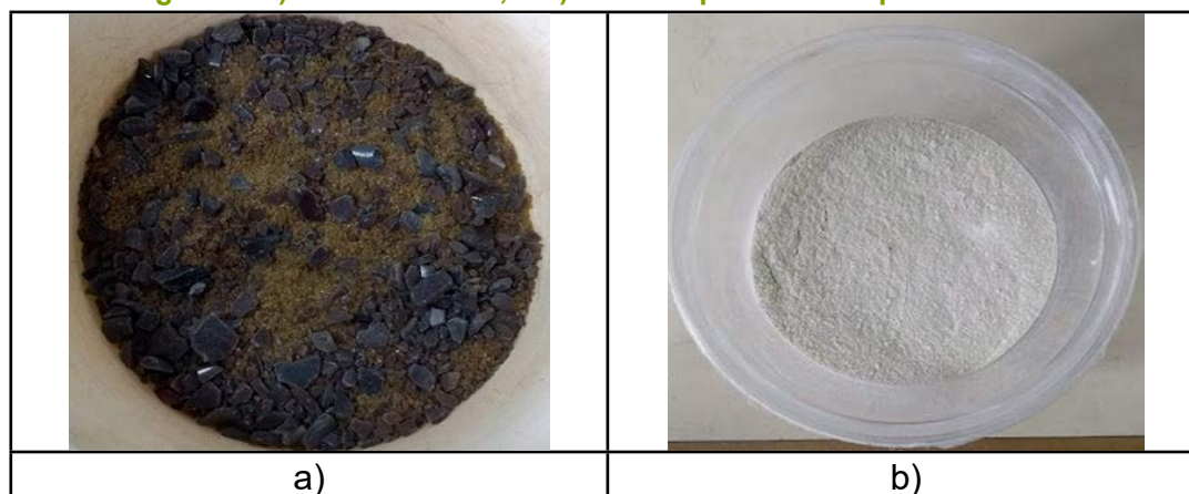
Figura 1: a) vidro triturado; e b) material passante na peneira nº 200.
