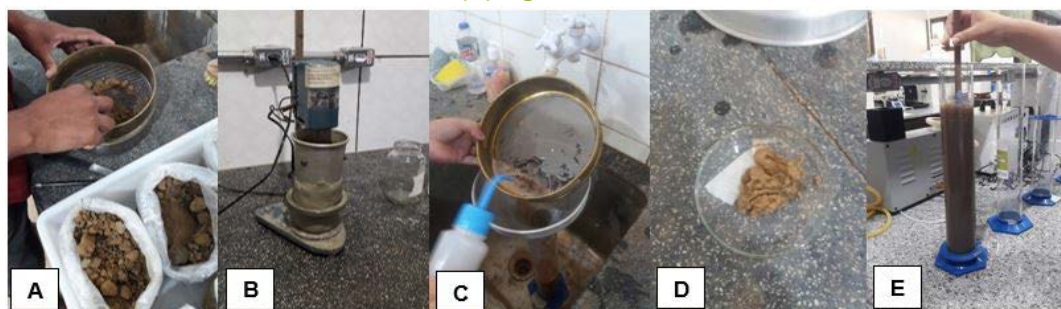
Figura 6 - (A) Destorroamento da amostra; (B) Agitação em coqueteleira; (C) Lavagem da solução com água deionizada; (D) Areia separada da solução pela peneira de malha 0,053 mm; (E) Agitação.
