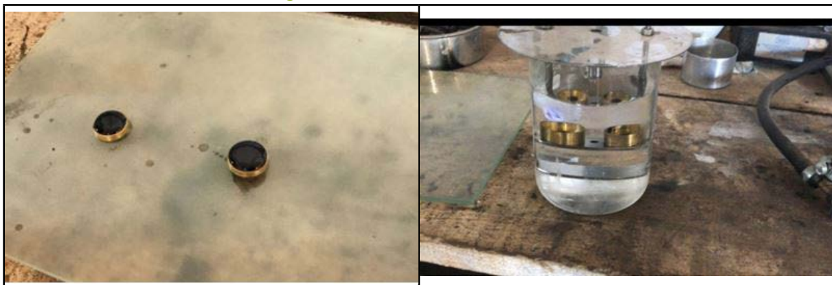
Figura 3 - Ponto de Amolecimento.
