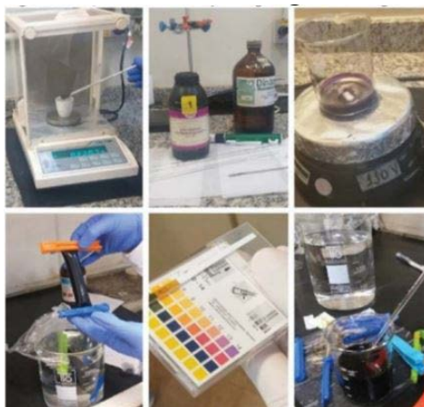
Figura 1 – Etapas de transformação do grafite em óxido de grafeno.
