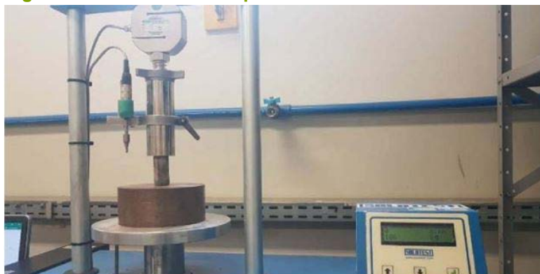
Figura 3 – Prensa adotada para ensaios referente ao 14° dia.
