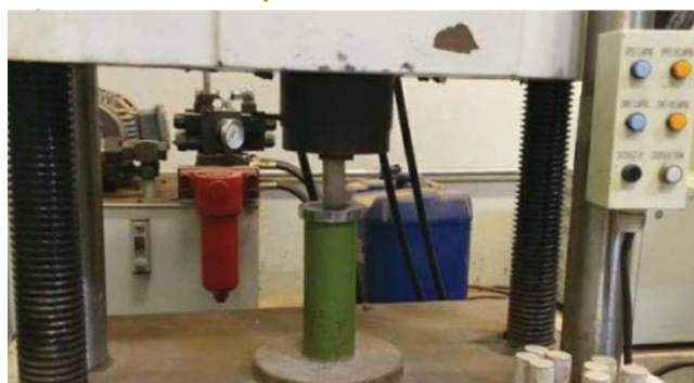
Figura 2 – Prensa adotada para ensaios referente aos 07° e 28° dias
