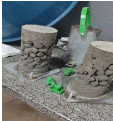
Figura 17 - Corpos-de-prova que apresentaram vazios de concretagem.
