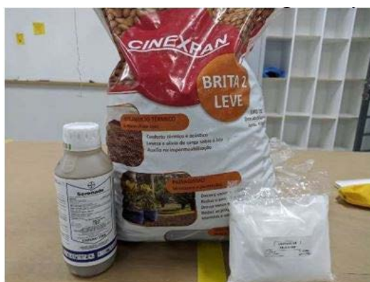
Figura 5 – Bacillus Subtillis em meio de cultura, argila expandida e lactato de cálcio.
