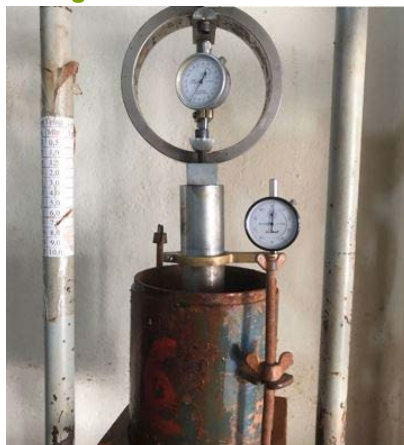
Figura 3 - Ensaio de CBR.
