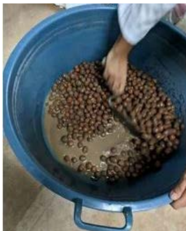
Figura 13 – Argila Expandida recebendo a mistura.
