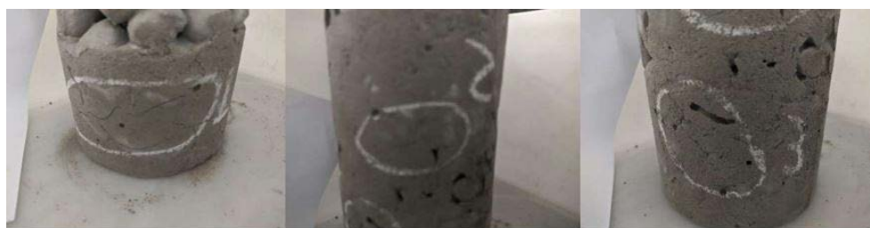
Figura 27 - Fissuração após 1 semana – CP2.
