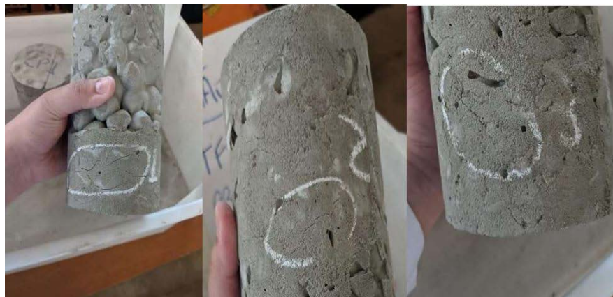
Figura 29 - Fissuração após 2 semanas – CP2.
