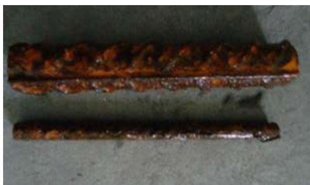
Figura 3 – Barras de aço comum após exposição de 672 horas à névoa salina, com intensa corrosão vermelha.
