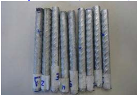
Figura 1 – Vergalhões galvanizados (bitola 10 mm) antes do ensaio.
