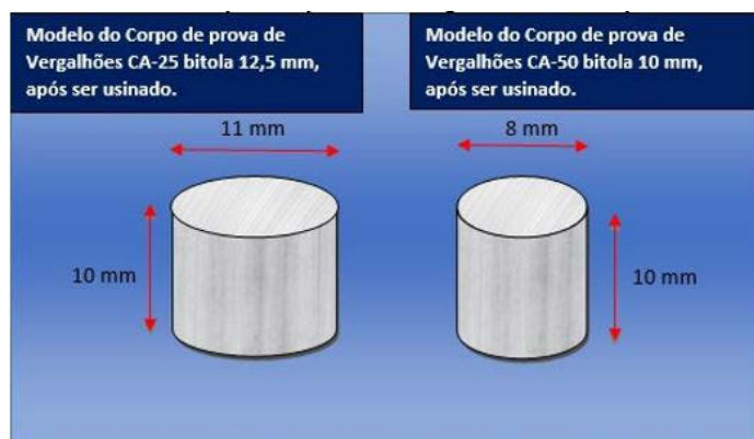
Figura 7 – Modelos dos corpos de prova de vergalhões usados para fazer os ensaios.
