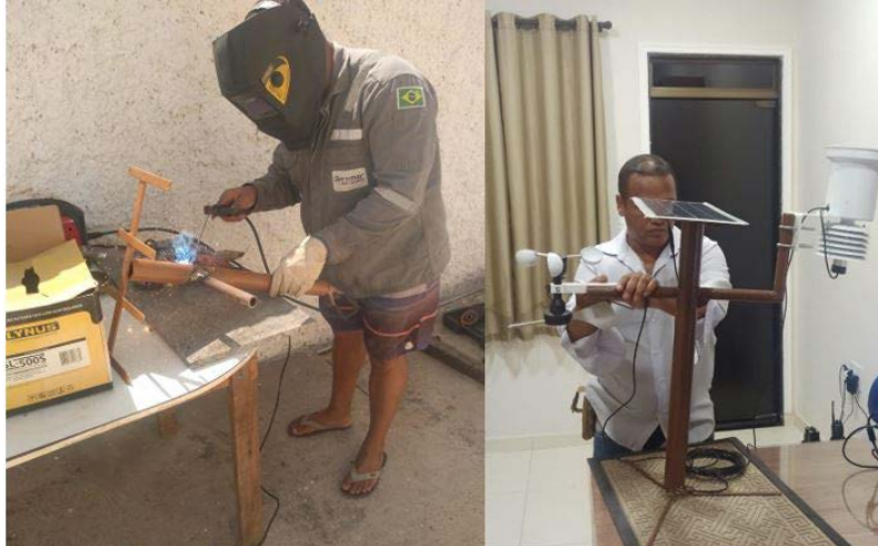
Figura 8 – Montagem protótipo 03 - Serralheria da estrutura da Estação meteorológica e acoplamento dos sensores e componentes.
