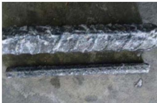
Figura 4 – Barras de aço galvanizado após exposição de 672 horas à névoa salina, ausência de corrosão vermelha.
