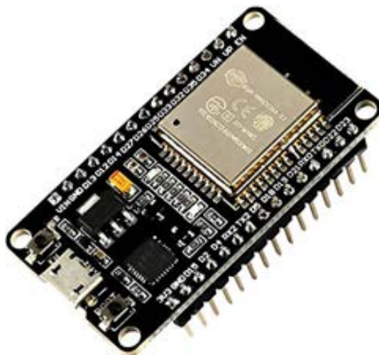
Figura 1 – Placa de desenvolvimento ESP32 ESP-32S 2,4 GHz modo duplo WiFi + processador microcontrolador Bluetooth Dual Core integrado com antena RF AMP filtro AP STA.
