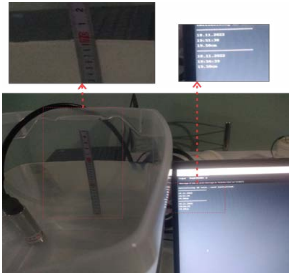
Figura 8 – Testes em laboratório Piezômetro de nível hidrostático
