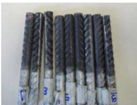
Figura 2 – Vergalhões galvanizados (bitola 10 mm) após ensaio.
