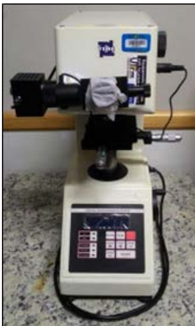
Figura 14 - Microdurômetro modelo TH710.
