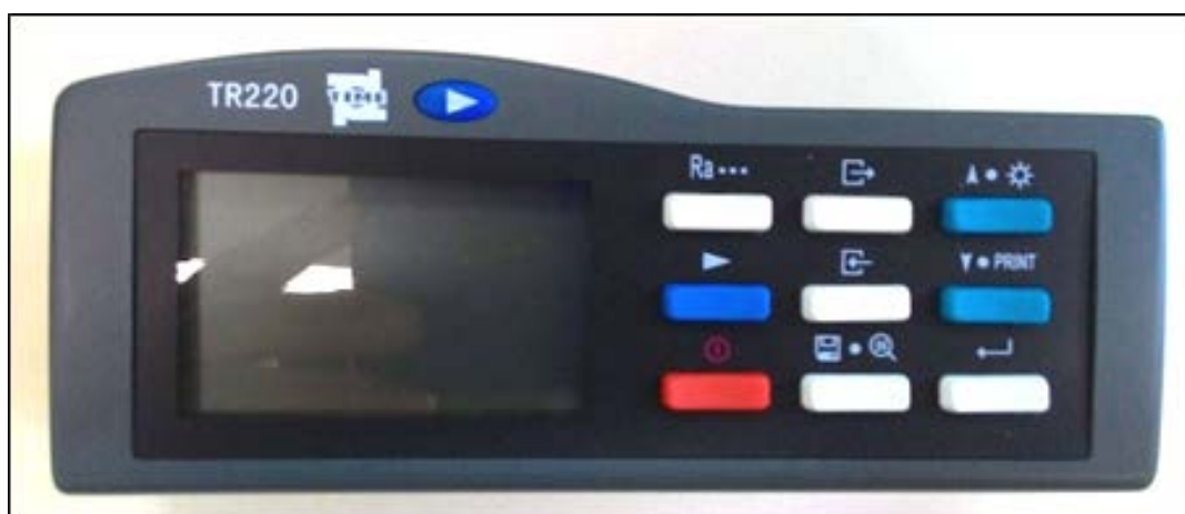
Figura 11 - Medidor de rugosidade de superfície TR220.
