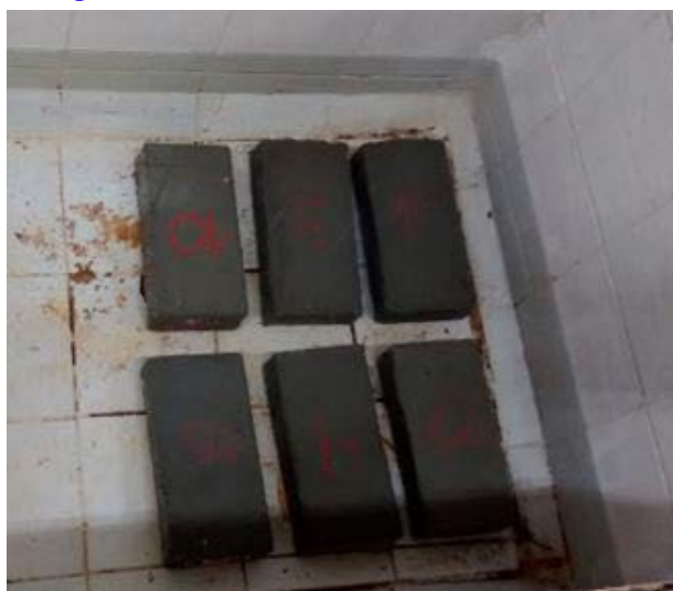
Figura 13 - Pavers em teste de submersão.
