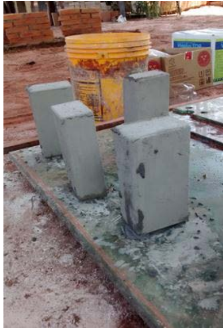
Figura 10 - Pavers recebendo impermeabilização.
