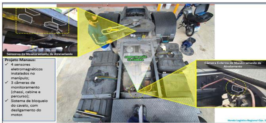
Figura 6 - Pontos de fixação dos sensores.
