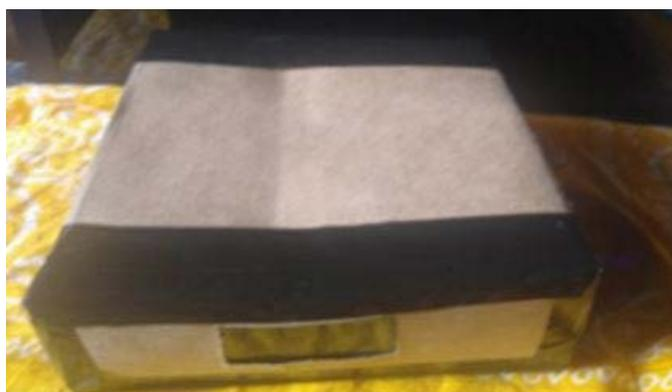
Em uma das extremidades, fazer uma abertura centralizada de 3 cm x 1,5 cm, conforme demonstra a Figura 2A. No centro da outra extremidade, fazer uma fenda vertical de aproximadamente 1 mm de espessura e 1,5 cm de comprimento, conforme mostra a Figura 2B
