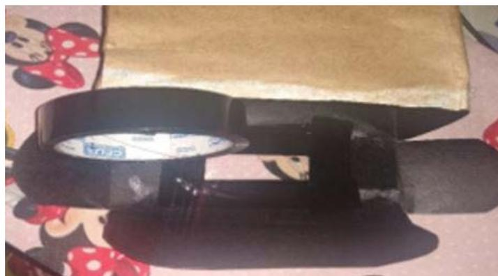
Para utilizar o espectroscópio, direcione a fenda para uma fonte de luz e olhe pela abertura coberta com CD. Algumas movimentações talvez sejam necessárias até encontrar o ângulo correto em que apareça o espectro da luz.
